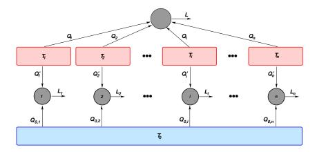
(En la figura, las flechas no indican la dirección de los flujos reales de calor y trabajo. Como siempre, si  $Q_i > 0$  el sistema absorbe calor y si  $Q_i < 0$  lo cede, e igual para el trabajo.)
