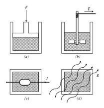
a) Empujando el pistón de un cilindro que contiene el sistema:  $L=-P_{\rm ext}\Delta V$ .
