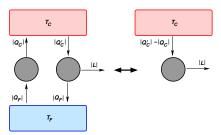
• Teorema de Carnot: Ninguna máquina térmica que opere entre dos fuentes de calor puede ser más eficiente que
