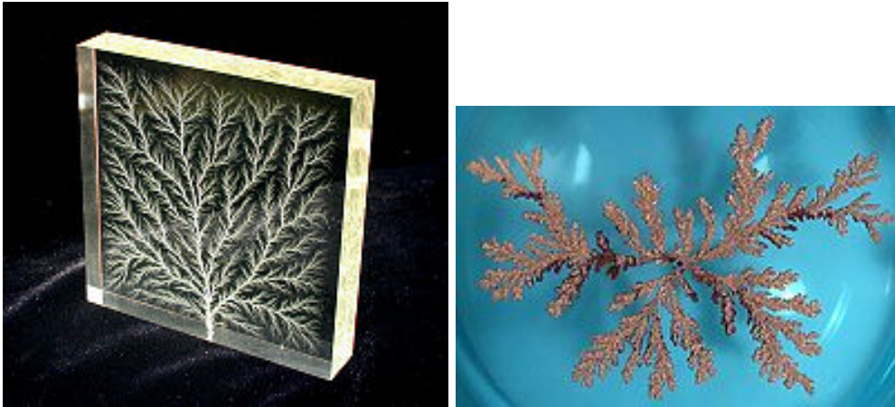
Figura 6 Fractales en un experimentos de ruptura dieléctrica y de agregación.
